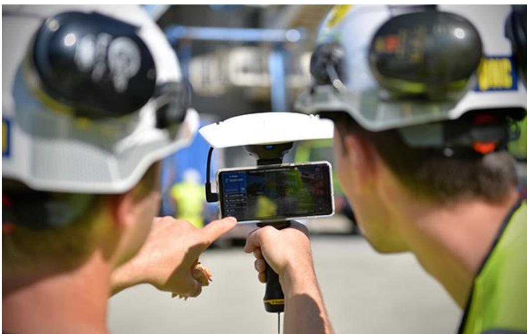
Figura 12 - Utilização do Sistema de Realidade Aumentada Trimble Sitevision na Ponte Randselva
